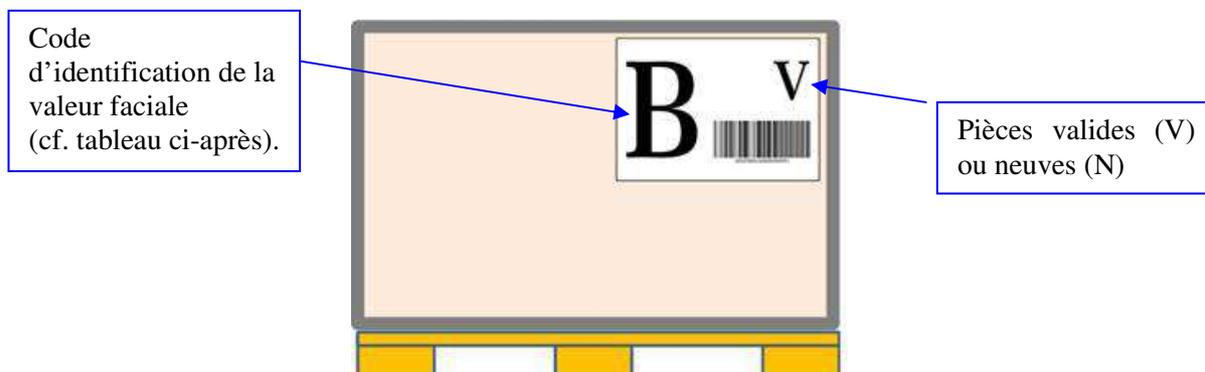
Il est à noter que les sacoches déjà constituées peuvent être conditionnées dans les mêmes conditions d'étiquetage dans des caisses en bois de dimensions extérieures 60 cm de large, 80 cm de long et 40 cm de haut.
